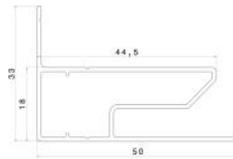
Maße der Führungsschienen bei Montage seitlich in der Nische oder in der Glasleiste: 50 x 33mm
