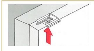
Schrauben Sie die Deckenträger für das Kopfprofil oben in die gebohrten Löcher, dann schrauben Sie die Träger für das Profil unten fest.
