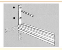
Bohren Sie die Löcher für die Schrauben in der Decke oder in der Wand für die Befestigungsträger vor. Schrauben Sie die Befestigungswinkel inklusive Montageprofil fest.
