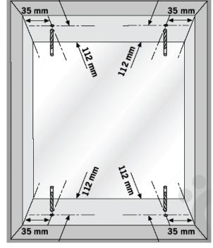
Bohren Sie die Löcher für die Schrauben in der Glasleiste vor. Beachten Sie hierfür die Vorgaben für den Bohrer in Skizze a und die Maßangaben für die Träger in Skizze b.
