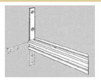
Schieben Sie auf jeder Seite des Montageprofils je einen Befestigungswinkel mit der längeren Seite in das Montageprofil. Verschrauben Sie diese gegebenenfalls.
