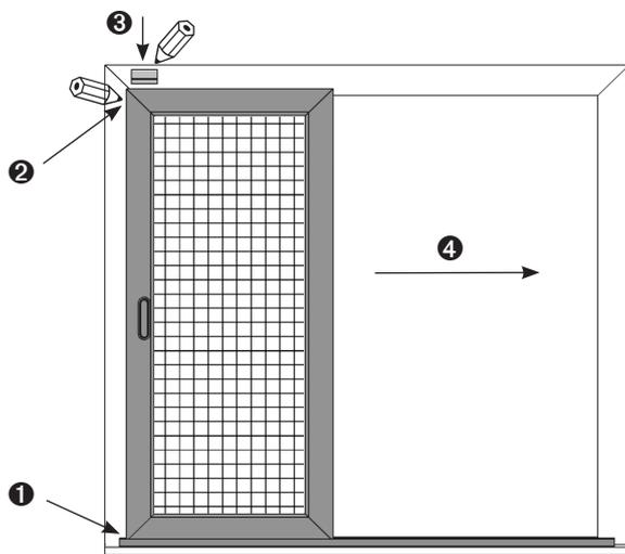
1 Schiebeflügel aufsetzen und gegen den Endanschlag fahren.
