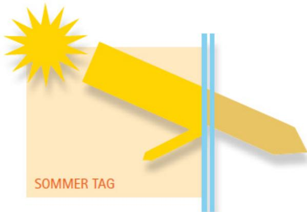
In Verbindung mit einem innen liegenden, hoch reflektierenden Sonnenschutz lässt sich der Wärmeeintrag auf unter 30% reduzieren.
